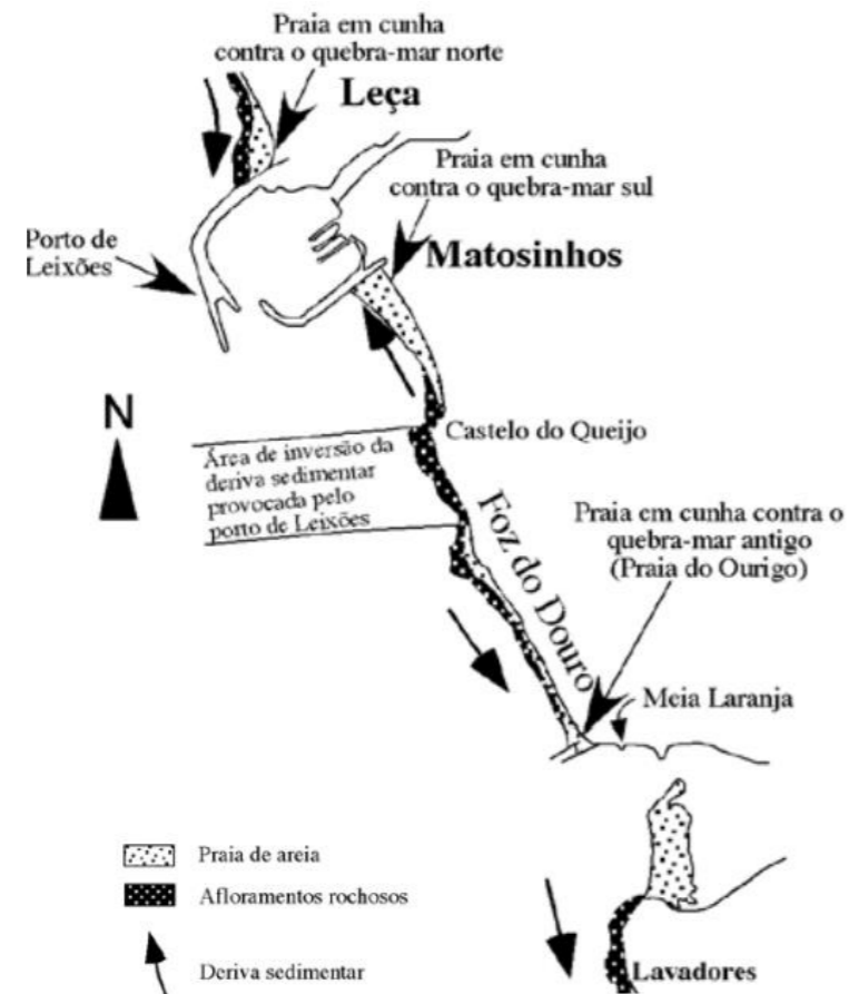
Figura 23. Esquema da deriva sedimentar entre o Porto de Leixões e o estuário do rio Douro (Fonte: Soares de Carvalho et al., 2006) (2) .
