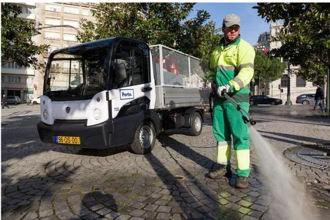
Figura 38. Veículo ligeiro elétrico para operações de lavagem de pavimentos e equipamentos.
